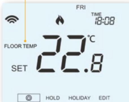
Wenn das neoStat so eingestellt wurde, dass es den Luft- und Bodensensoren verwendet, wird die Raumtemperatur standardmäßig angezeigt.
