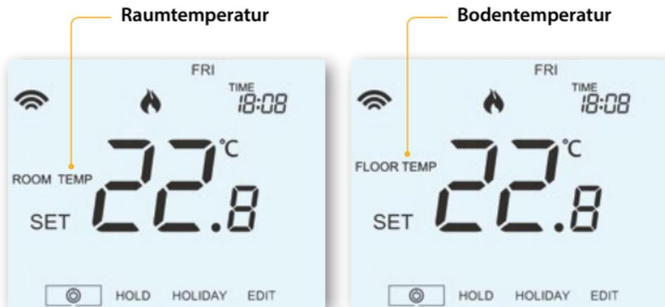
Wenn das neoStat so eingestellt wurde, dass es den Luft- und Bodensensoren verwendet wird, wird die Raumtemperatur standardmäßig angezeigt.
